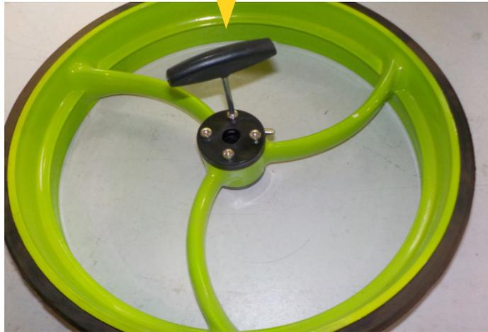
2. Hebeln Sie die Radkupplung mit einem Schraubenzieher aus dem Rad.
