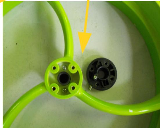
3. Neue Radkupplung auf das Rad drücken und wieder mit den Inbusschrauben befestigen.
